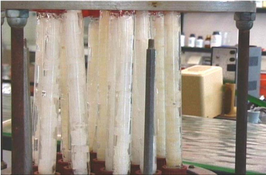
Abbildung 3: Die Immobilisationseinheiten des zweiten Reaktors anfangs der Einfahrphase – ohne Biofilm
