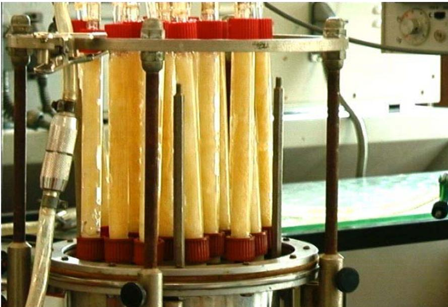
Abbildung 4: Die Immobilisationseinheiten des zweiten Reaktors nach der Einfahrphase – mit Biofilm
