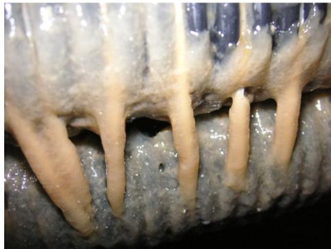
Abb. 3: Biofilm auf Trägermaterial im Biofilter
